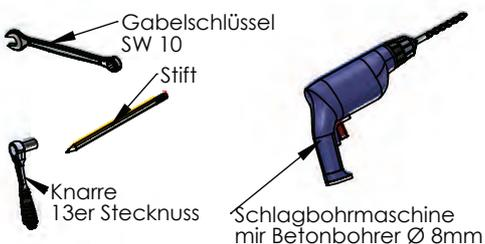
Schlagbohrmaschine mit Betonbohrer Ø 8mm
